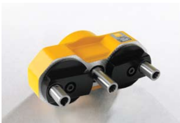
TESTA A 3 MANDRINI REGISTRABILI IN LINEA TIPO 119 3 SPINDLE IN LINE ADJUSTABLE HEAD TYPE 119
